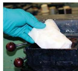
Innerhalb weniger Minuten ist der Klebstoff aufgeschmolzen und zum Auftrag bereit. Die Reinigung des Schmelzbeckens erfolgt in bekannter Weise mit Reinigungsgranulat KLEIBERIT 761.7.
