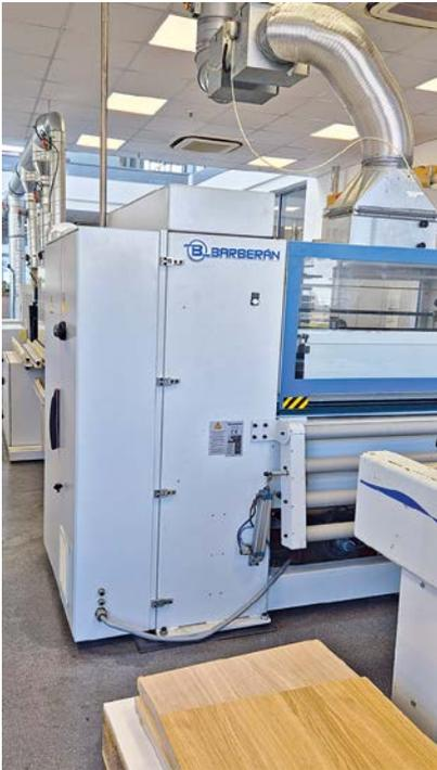
**Auf dieser Laboranlage in Weingarten kann das „Hot Coating“-Verfahren getestet werden. Zur Ligna präsentiert Kleiberit eine (verkürzte) Rolle-zu-Rolle-Anlage mit einer Nutzbreite von 1.600 mm, die von Huser gefertigt wurde**
