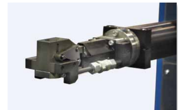
Смесительная головка высокого давления с разрешения Изотерм/Швейцария
