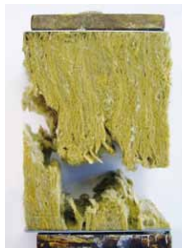
Прочность на растяжение (разрыв по материалу, минеральная вата)
