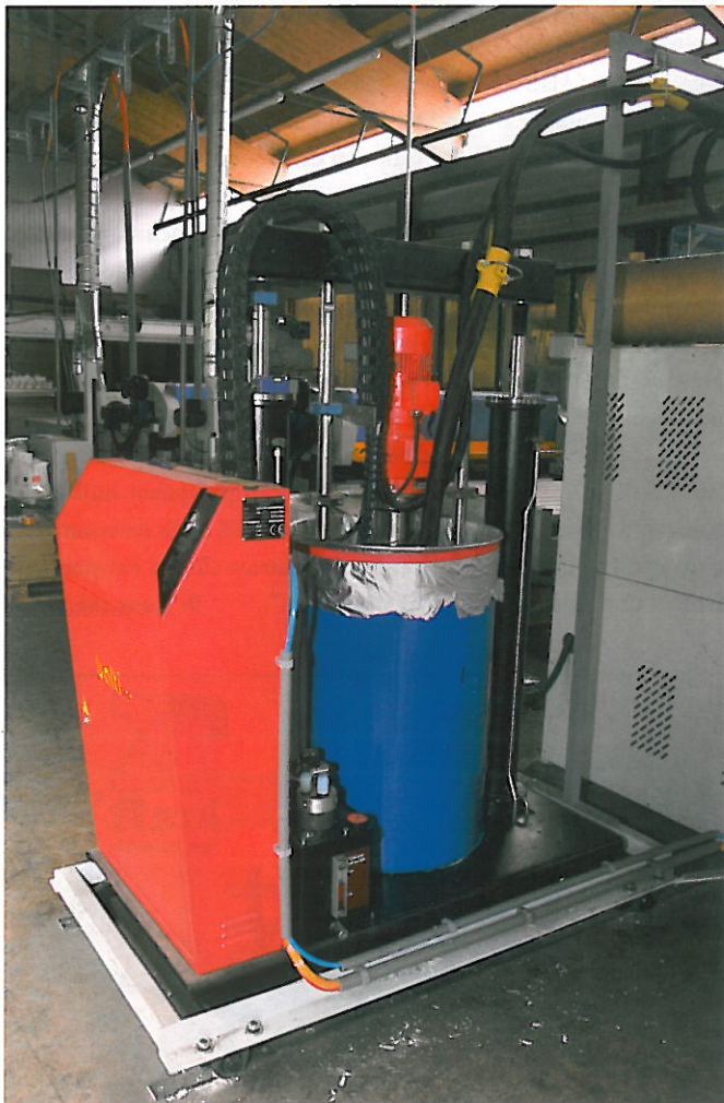
Einsatz einer Fassschmelzanlage vom Typ HSP-200-SAH an einer Walzenauftragsanlage bei dem Fußbodenhersteller Li&Co in Münstair (CH) (Foto: Bucki)
