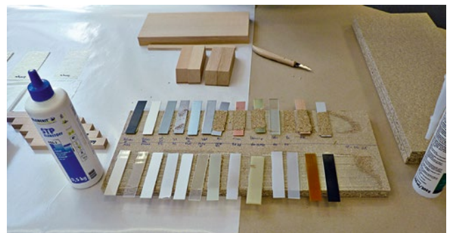
Schon nach kurzer Zeit sind die Probekörper im Test nicht mehr vom Untergrund zu lösen.
