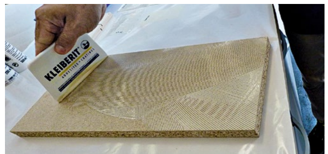
Der Klebstoff lässt sich sehr einfach mit Spachtel, Pinsel, Rolle oder Düsenaggregat auftragen.
