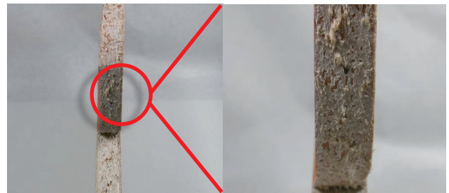
Deutlicher Spanausriss beim Schälversuch!!
