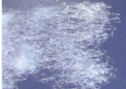
Klebstoffauftrag im Sprühverfahren
