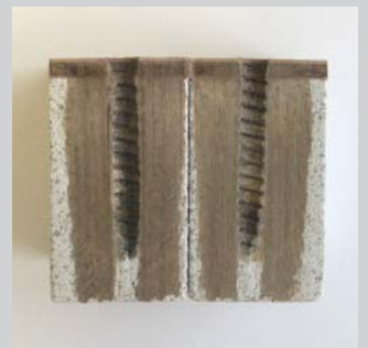
Querschnitt: Bohrlochverstärkung einer Gipsverbundplatte mit KLEIBERIT 555.6; gut sichtbar entstandene Innengewinde
